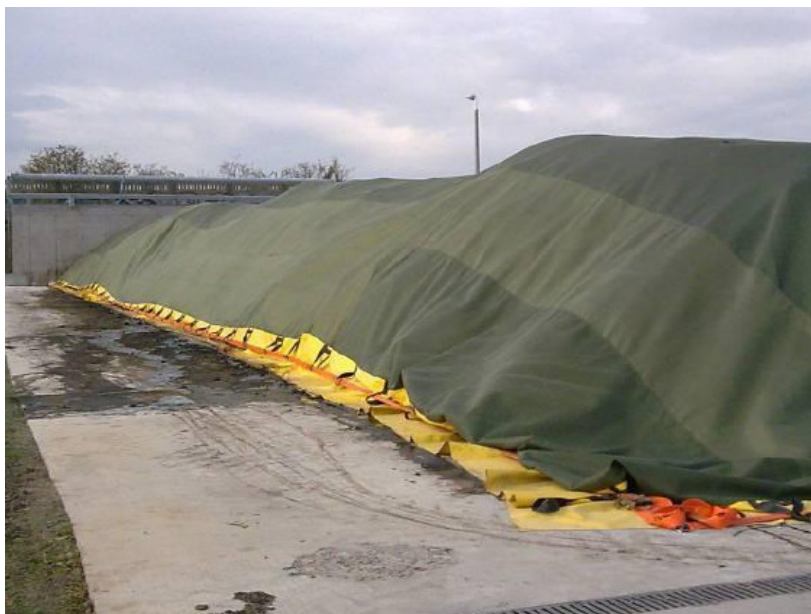
Слика 3-112: Надворешно компостирање во бразди со стог покриен со мембрана за заштита и задржување на миризбата
