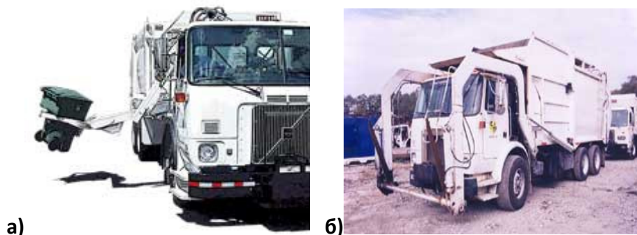
Слика 3-76: (а) Камион со странично товарење и (б) Камион со предно товарење
