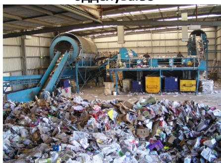
Слика 3-91: Место за истурање, подвижна лента, ротирачко сито, лента за рачно одделување
