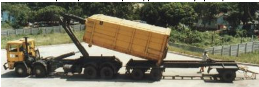
Слика 3-81: Транспортно возило претоварува полн контејнер на приколка
