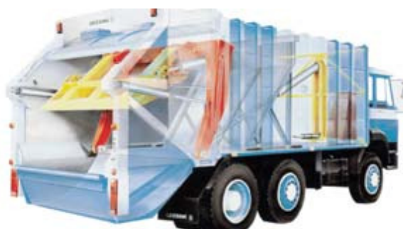
Слика 3-66: Пример за камион за собирање со преса
