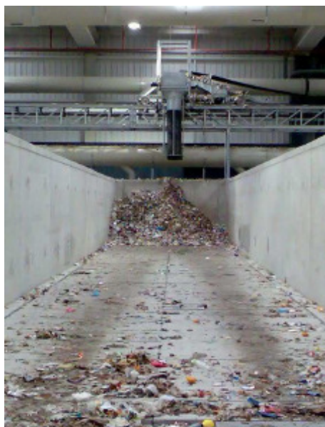
Слика 3-111: а) компостирање во тунел (ленти) со аерација преку перфориран под, б) компостирање во вреќи
